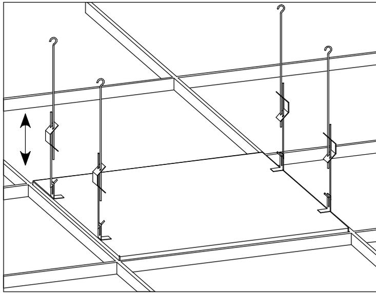
Рисунок 5 - Схема установки светильника на крючках
