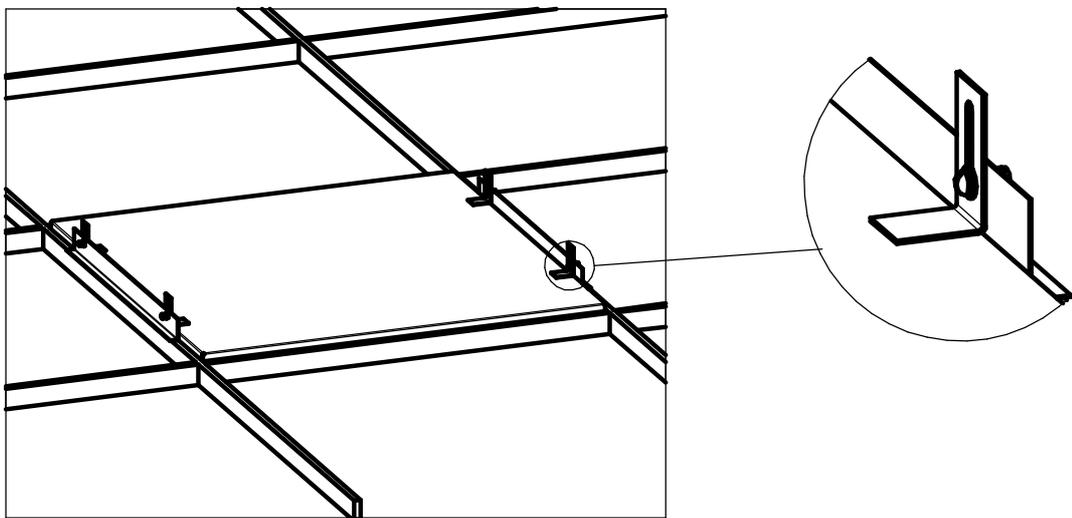
Рисунок 4 - Схема установки светильника на уголках
