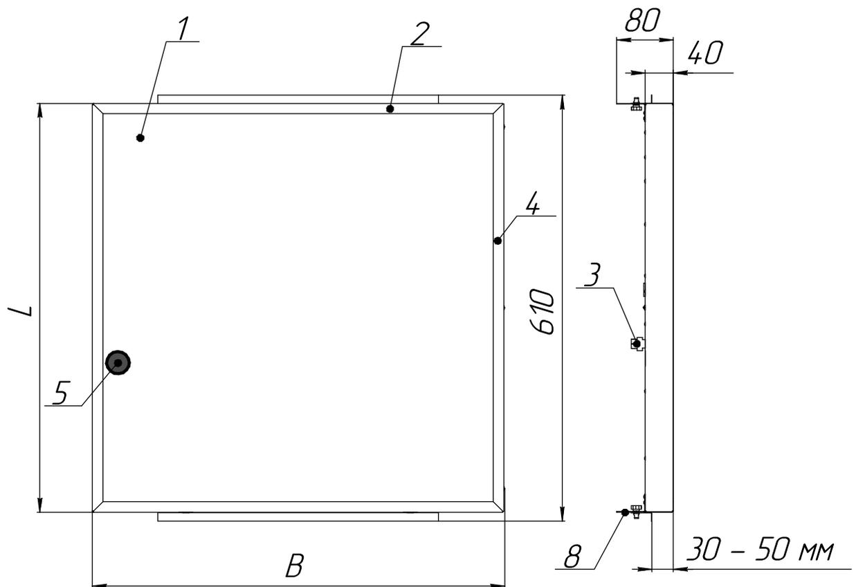
Рисунок 3 - Общий вид светильника серии ДВО12 GR EM
