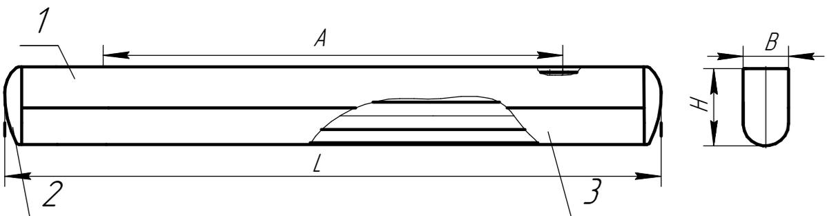
Рисунок 3.ЛПО46-36-604. 1.Корпус в сборе; 2.Крышка; 3.Рассеиватель
