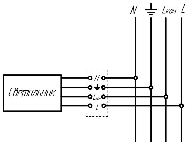
Схема подключения светильника к сети
