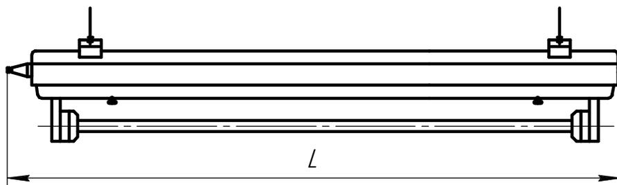
Рисунок 1: Общий вид светильников серии ПВАМ, АСП22.
