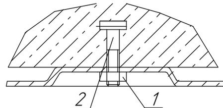
Рисунок 6. Крепление светильника на монтажную поверхность.
