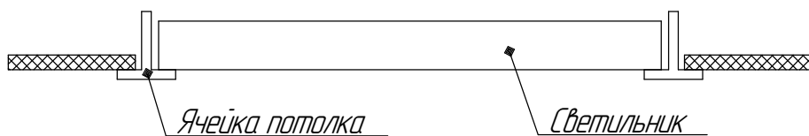
Рисунок 2 - Схема установки светильника
