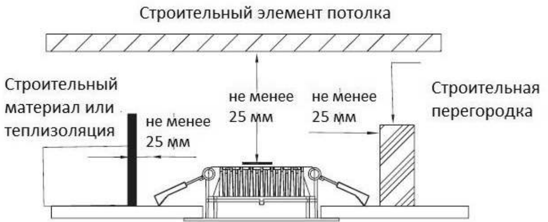
Рисунок 2 - Схема установки светильника в потолок
